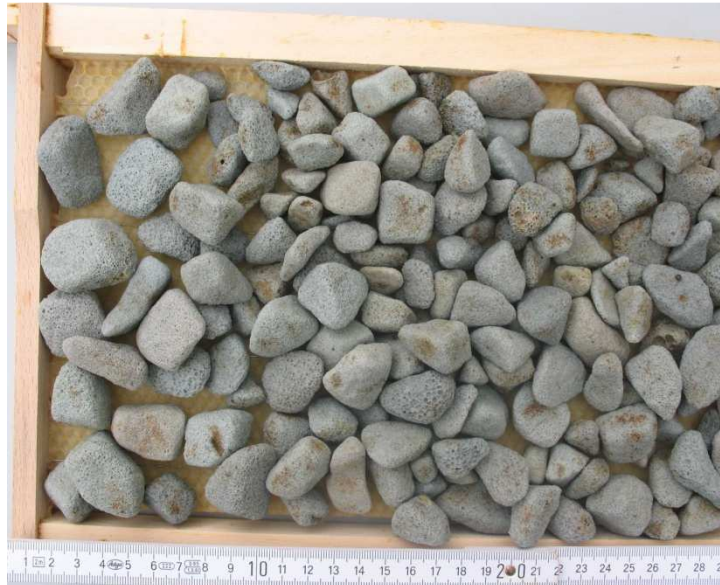
Misapor® in der Schwabenimker-Qualität, bereits mehrfach verwendet mit Wachsresten auf einer Zanderwabe liegend, Größenvergleich siehe Maßstab am unteren Bildrand
